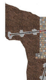
Consolidamento muri di sostegno in pietra e cemento armato
